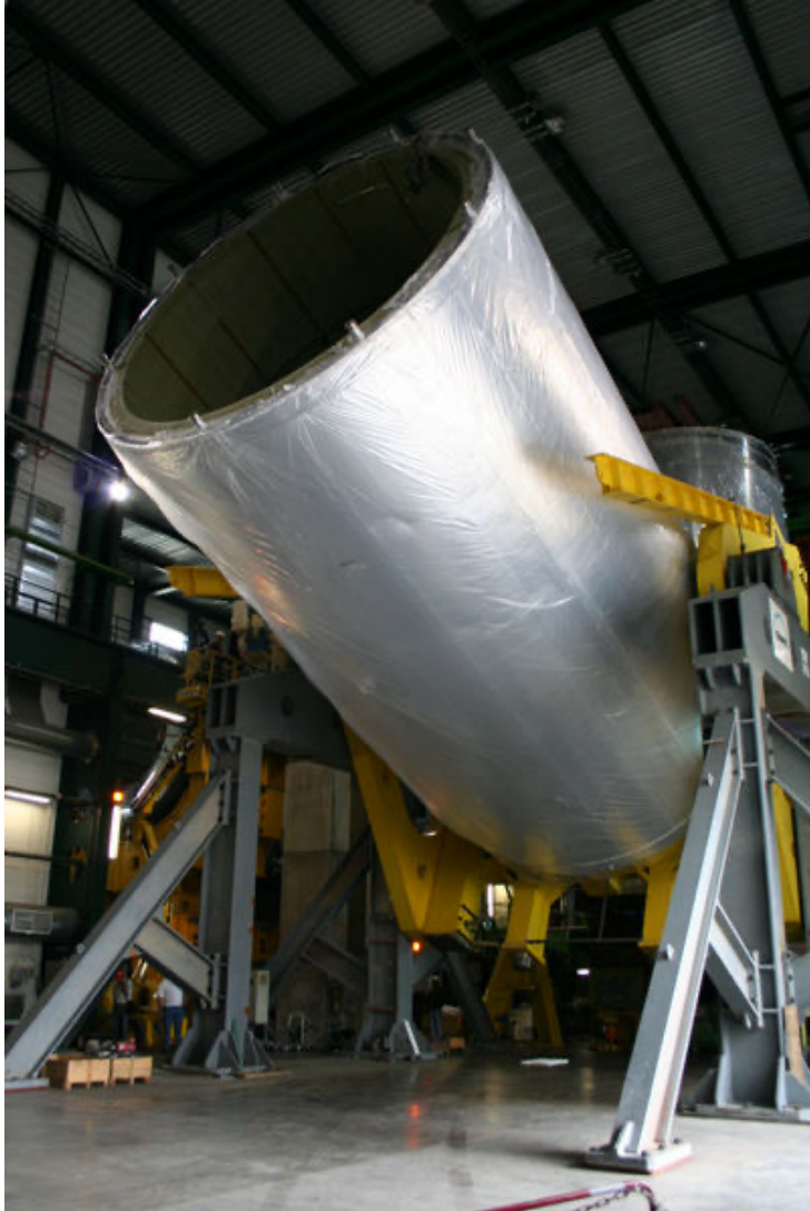
CMS 초전도 자석 설치를 위한 초대형 장비 개발 (동양중공업 제작)
